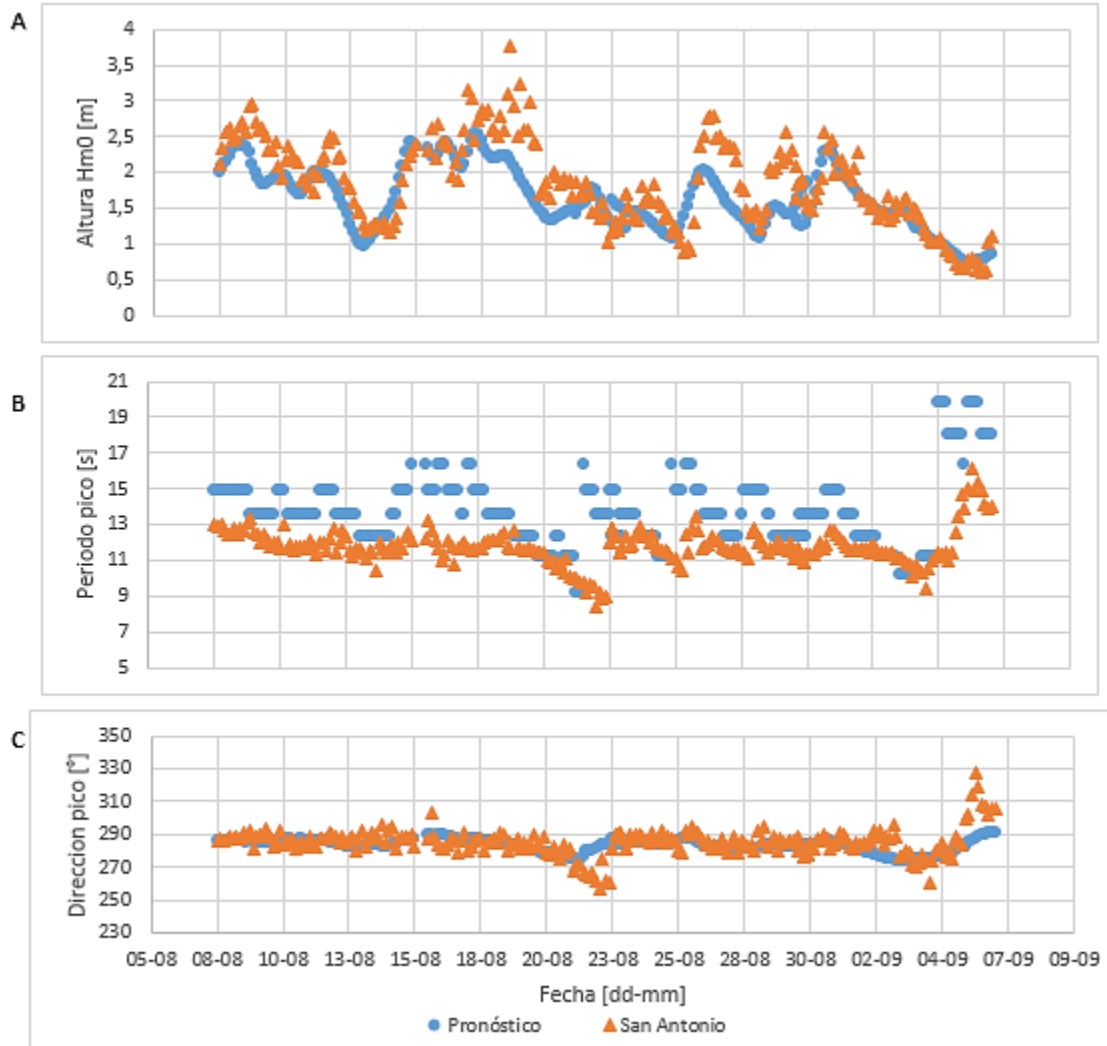
Figura 6: a) Serie de tiempo para H_{m0} modelada (punto azul) y H_{m0} registrada por el ADCP del puerto de San Antonio (triángulos naranjos). b) Serie de tiempo para T_p modelado (punto azul) y T_p registrados por el ADCP del puerto de San Antonio (triángulos naranjos). c) Serie de tiempo para Direcciones pico [°] modelada (punto azul) y Direcciones pico [°] registrados por el ADCP del puerto de San Antonio (triángulos naranjos).
